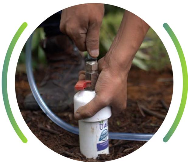
Proceso de generación de presión inversa en sondas de succión para simular la extracción de solución del suelo por parte de las raíces, de esta manera se toma la muestra de la solución del suelo.
