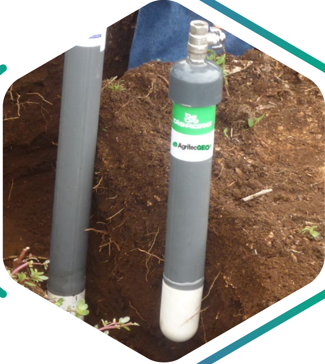
Sonda de succión, con cerámica porosa que simula el proceso de absorción de nutrientes por parte de las raíces, permitiendo tomar muestra de la solución del suelo a diferentes profundidades en el perfil del suelo.
