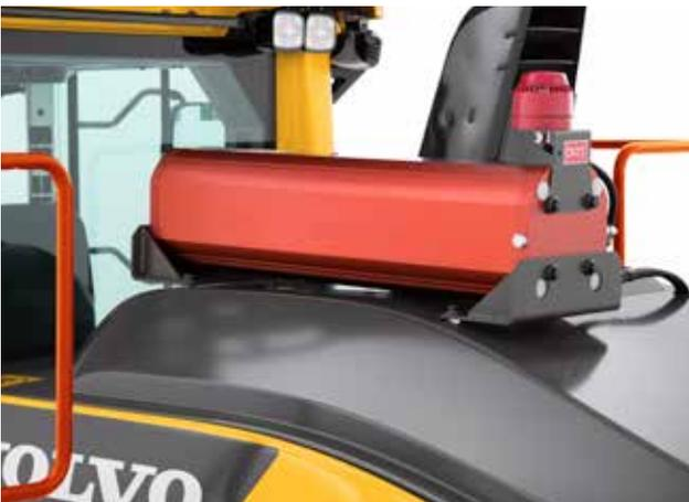
**Refrigeración del aceite del eje externo**
