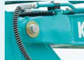
Forjado delantero del boom
