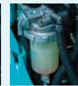
Pre filtro de combustible con una función de separador de agua
