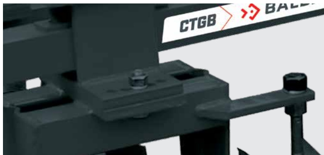
Sistema de reversão manual com regulagens até 360°. Manual reversion system, 360° adjustment. Sistema de reversión manual con regulación para 360°.
